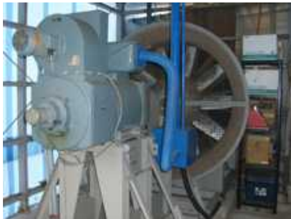
写真 - 1 風洞 プロペラ、モーター部
