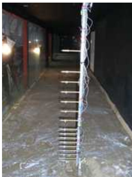
写真 - 3 熱線風速計および風洞内部
