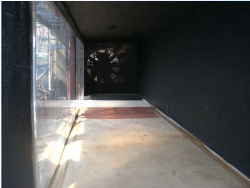
写真 - 6 ベニヤ板敷設区間
