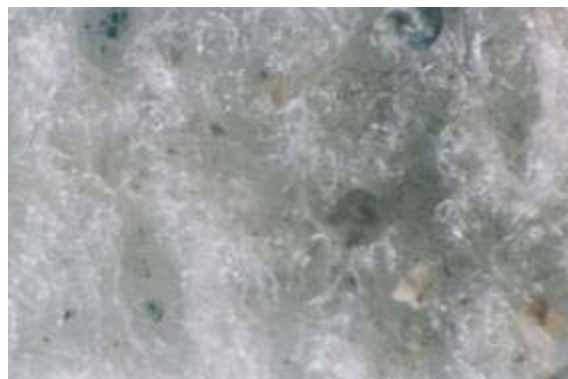
デイリーキャップ 3ヶ月経過状況 表面に凹凸が確認出来る。 繊維が分解し、無くなったためと思われる。
